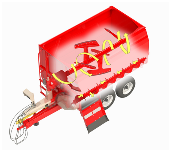
Figura. Sentido de fluxo de mistura em vagões misturadores com rotor e pás tombadoras.
