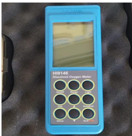
Figura 2 - Sonda modelo Hanna HI 9146
